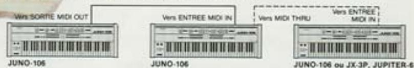
Le JUNO-106 peut contrôler un autre clavier MIDI. En utilisant les prises MIDI THRU, le JUNO-106 peut alors contrôler plusieurs claviers simultanément. En réglant les claviers pour qu'ils produisent par exemple des sons de corde, on obtiendra un ensemble de sonorités semblable à celui d'un orchestre tout entier.
