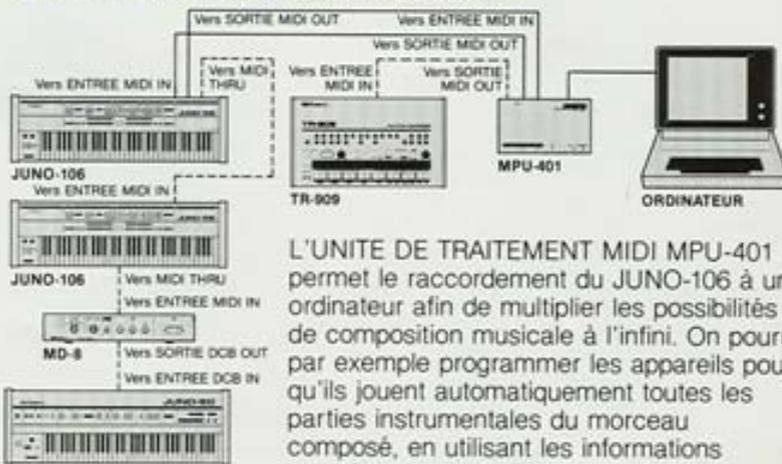
L'UNITE DE TRAITEMENT MIDI MPU-401 permet le raccordement du JUNO-106 à un ordinateur afin de multiplier les possibilités de composition musicale à l'infini. On pourra par exemple programmer les appareils pour qu'ils jouent automatiquement toutes les parties instrumentales du morceau composé, en utilisant les informations stockées dans la mémoire de l'ordinateur.
