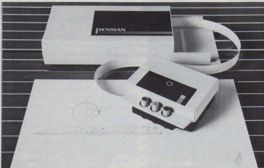
Le Plotter de Penman se contrôle automatiquement grâce à des capteurs optiques.
