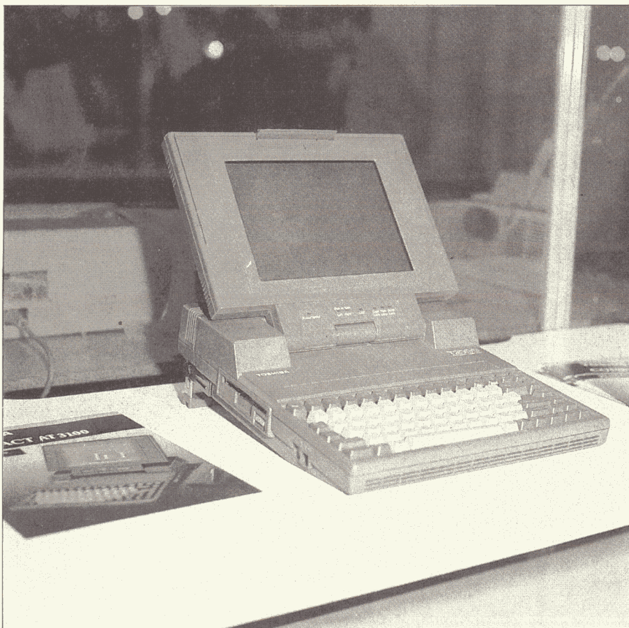
L'ordinateur portable PC 2100 de Toshiba est équipé d'un écran à plasma.
