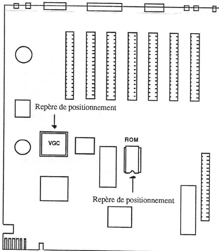
**Remplacement du VGC :** Si nécessaire, retirer à l'aide de l'outil d'extraction \* 076-0264 le composant VGC et le réinsérer dans son sachet d'identification.
