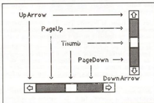
Figure VII.6. Les différentes parties des barres de défilement.
