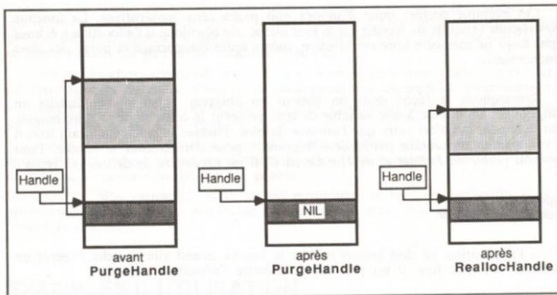
Figure II.6. Fonctionnement de PurgeHandle et RealloCHandle.
