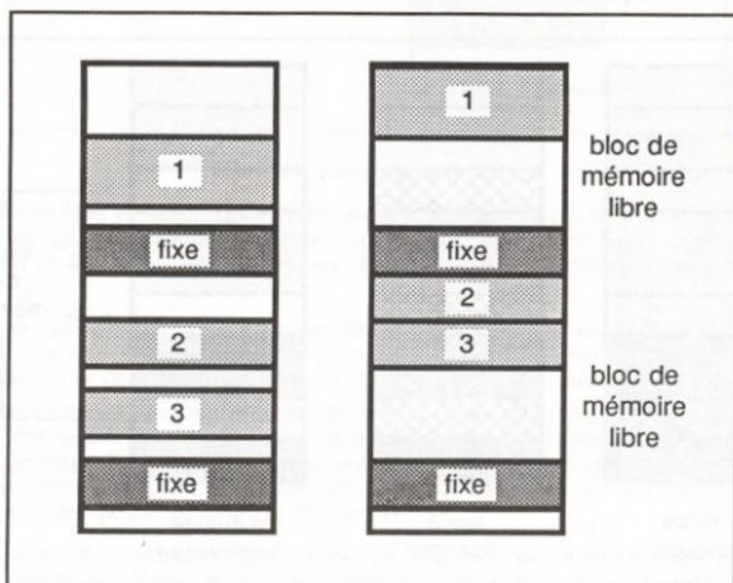
Figure II.5. Les blocs fixes peuvent générer le compactage.
